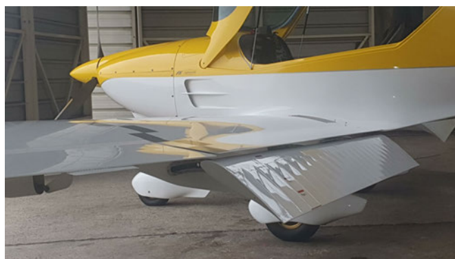
Les volets Fowler sortis au 3ème et dernier cran
