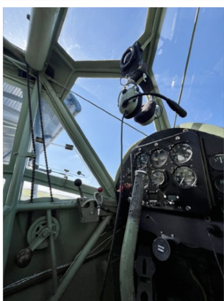
Notez l'ingénieux système pour déployer les volets avec une chaîne de vélo
